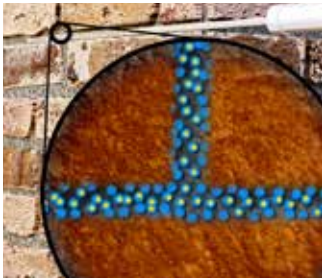
Standard-Creme: Vermischung der Wirkstoffe mit Porenwasser bei durchfeuchteten Mauerwerken und dadurch Verdünnung der Wirkstoffkonzentration sowie unkontrollierte Verteilung der Wirkstoffe im Mauerwerk.
